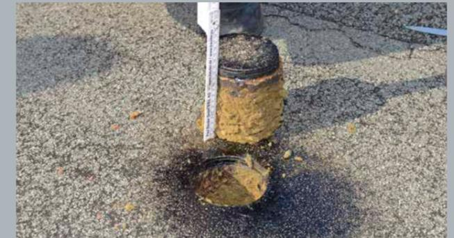
An ausgesuchten Stellen wird ein Spezialwerkzeug durch die Dachabdichtung und die Wärmedämmung vorsichtig bis zur Dampfsperre eingedreht und eine entsprechende Materialprobe entnommen. Diese wird einer Sichtprüfung unterzogen.
