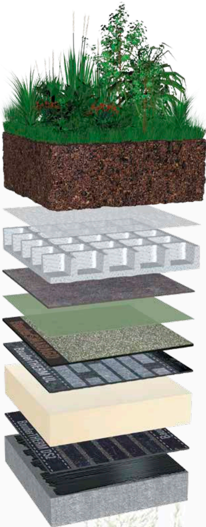
Hohes Speichervermögen mit der Wasserspeicherplatte WSP 75
