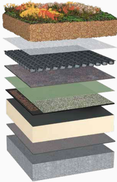
Druckbelastbare Drainage mit Drän- und Speicherelement DSE 20
