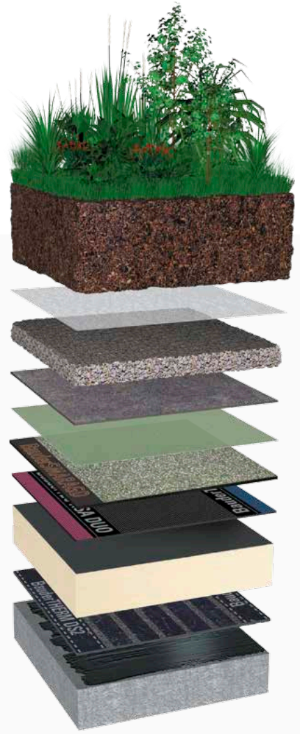
Schüttstoff-Drainage mit Bauder Mineraldrän
